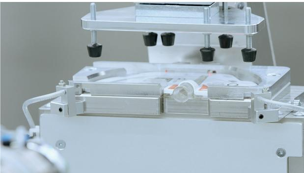
Auf die Disk (vorne der runde Probeneinlass) wird zum Schutz der Folie ein Deckel geklipst © Medienproduktion Holzer
