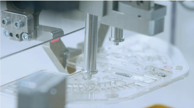
Hier wird eine Disk mit einem kugelförmigen gefriergetrockneten Reagens (Lyophilisat) befüllt © Medienproduktion Holzer
